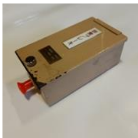
非常ブレーキスイッチ
